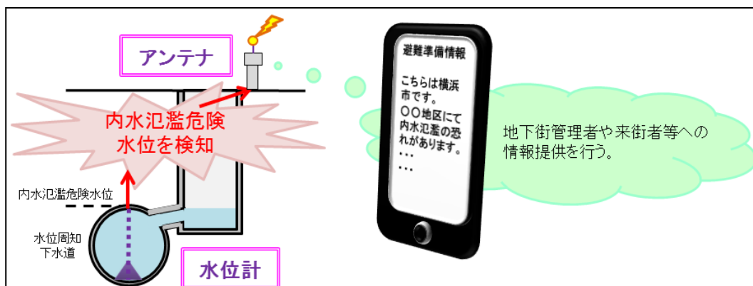
図 2-23 水位周知下水道の概要図
