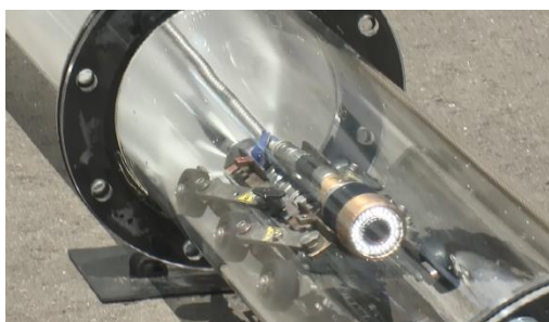
図 2-4 スクリーニング調査の実施(左、中：ノズルカメラ、右：撮影画像)
