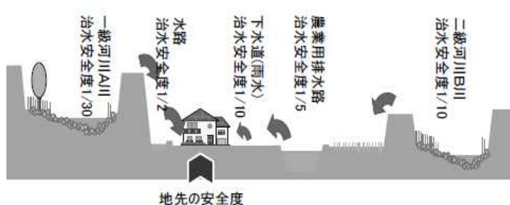
図 各施設の「治水安全度」と「地先の安全度」
