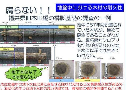
図 丸太は地下水位以深では腐朽しない
