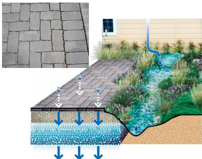
図6-4 J・ミックスを使った雨水貯留浸透基盤の機能
