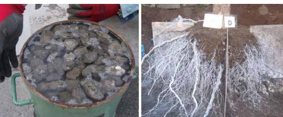
写真5-1 J・ミックスの外観(空隙率は41%)
