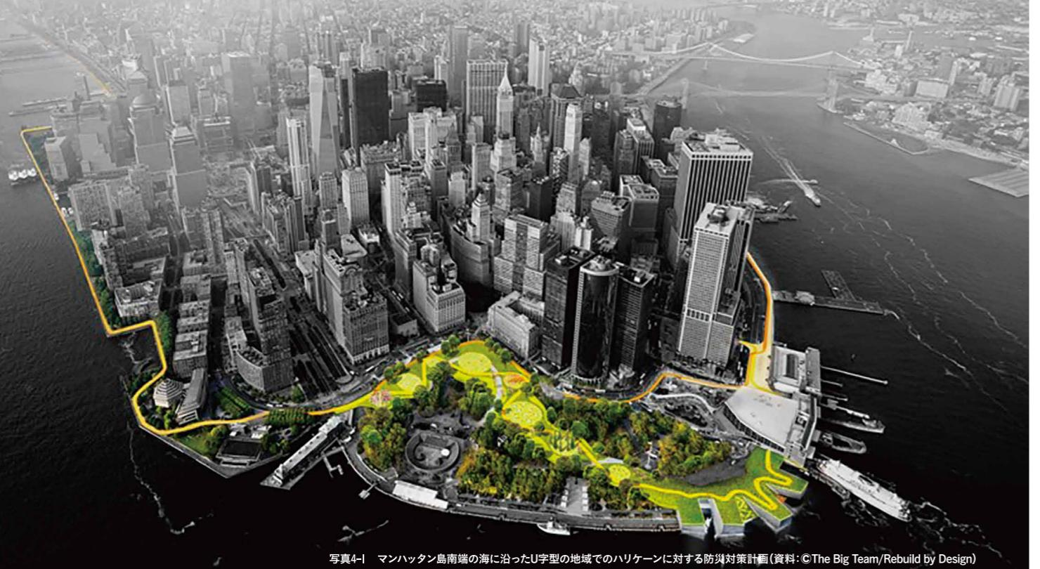
写真4-1 マンハッタン島南端の海に沿ったU字型の地域でのハリケーンに対する防災対策計画(資料:©The Big Team/Rebuild by Design)
