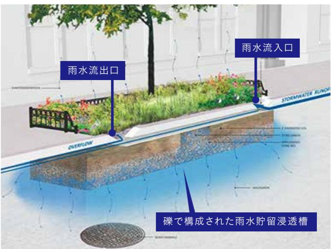
図4-4 レインガーデン断面模式図(2016年)
